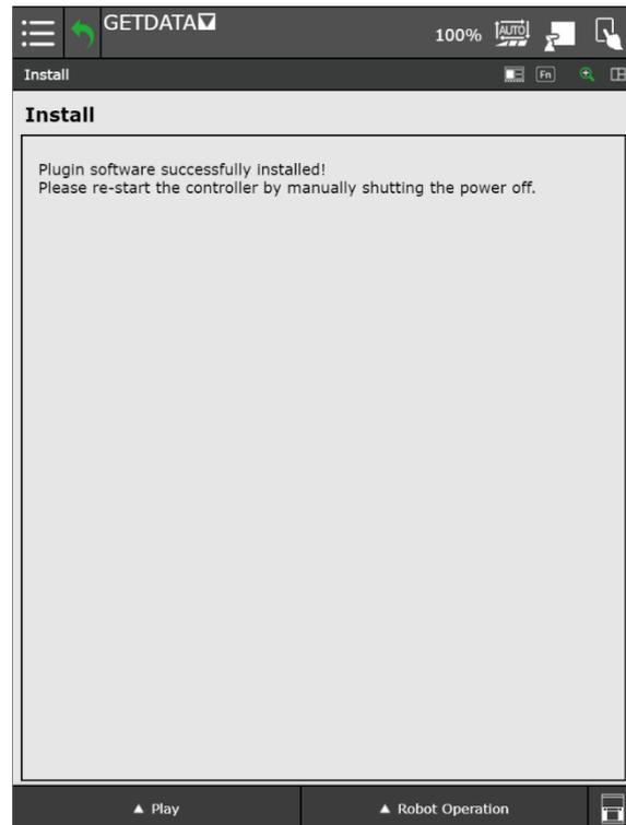
Nach der Aufforderung zum Neustarten der Robotersteuerung schalten Sie diese am Hauptschalter aus und nach etwa zehn Sekunden wieder ein oder nutzen Sie die Neustart-Funktion über den Teach Pendant (weitere Informationen hierzu entnehmen Sie der Anleitung der Robotersteuerung). Das Teach Pendant muss nicht neu gestartet werden. Warten Sie, bis sich das Teach Pendant erneut mit der Robotersteuerung verbunden hat.
